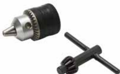
31904C Borrchuck med nyckel 10 mm UNF 3/8×24
